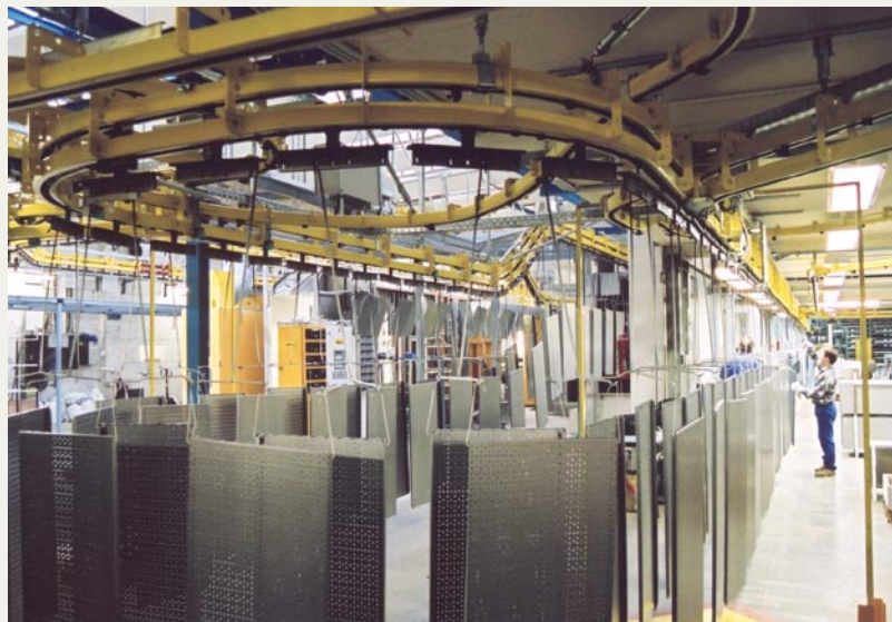
Power+Free mit Kettenlaufwerk. Die dichte Behängung erinnert an einen Kreisförderer. Die Weichen und Stopper sind charakteristisch für die Power+Free-Technik.
