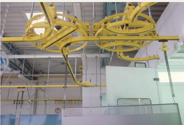
Handhängebahn: Drehscheibe vor der Einfahrt in eine Lackierkabine. Im Hintergrund eine Weiche vor einer Speicher- und Bereitstellungsstrecke.
