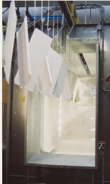
Power+Free-Förderer mit Kettenlaufwerk durch die Pulverbeschichtung. Gut zu sehen: die dichte Behängung mit Fördergut, ähnlich der eines Kreisförderers.
