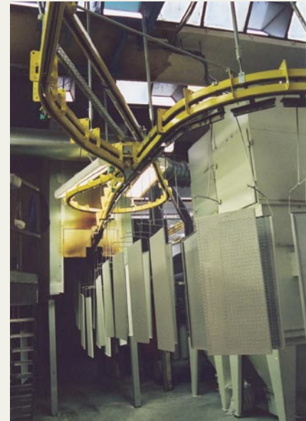
Power+Free-Förderer mit Kettenlaufwerk. Die Kettenlaufwerke können aus zwei unterschiedlichen Beschichtungsbereichen in einen gemeinsamen Trockner fahren.
