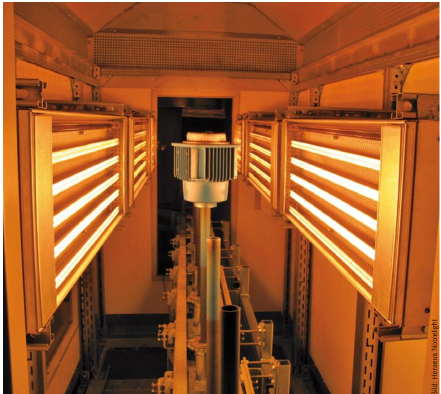
Der Einsatz von Infrarot-Strahlern erwies sich bei der Pulverbeschichtung der Motorgehäuse als optimale Lösung
