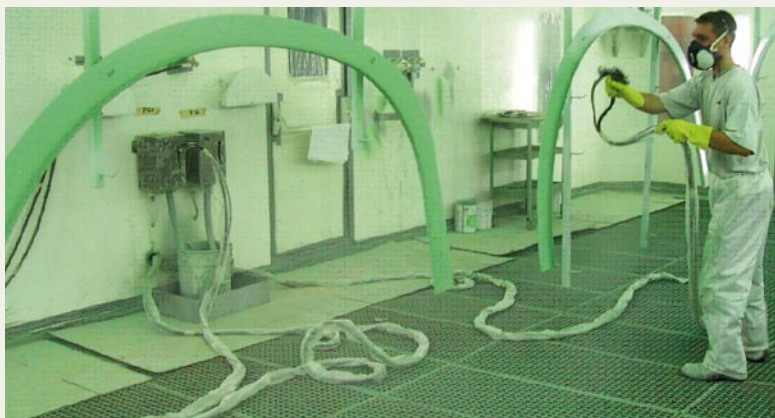
▲ Lackierung von Flugzeugteilen im Airbuswerk Stade: Eine einwandfreie Lackierqualität ist hier ein Muss.
