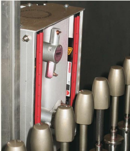
◀ Abblasen der Kunststoffteile mit ionisierter Luft
