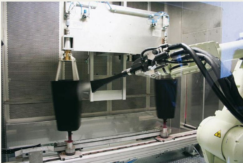
▲ Die Pflanztöpfe werden mit CO 2 gereinigt; eine automatische Zentriereinheit verhindert das Kippen der Teile
